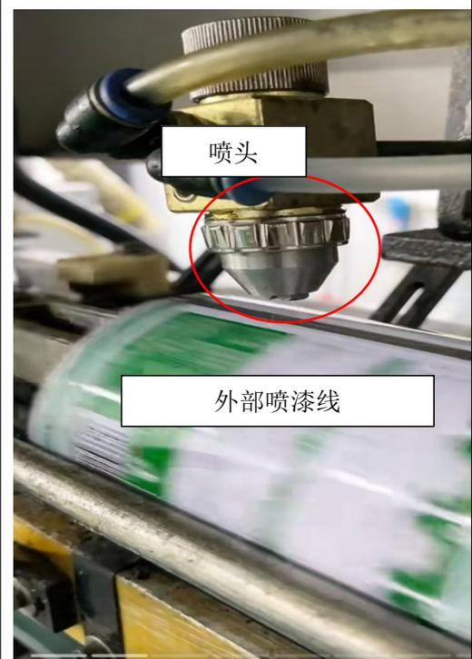
外喷（焊缝）
